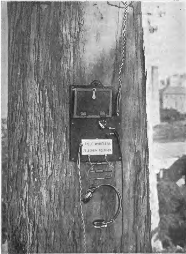
Figur 29. Empfangsapparat nach Major Squier.
